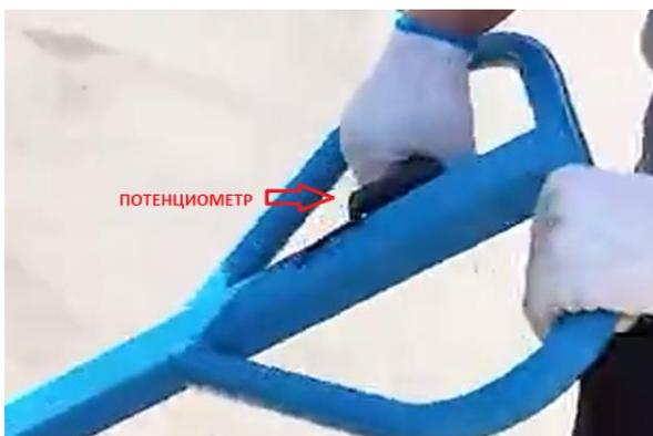
Для начала движения подъемника выберите направление движения, вперед или назад. Отклоните ручку на себя и медленно отклоните потенциометр и подъемник начнет движение в выбранном вами направлении.
