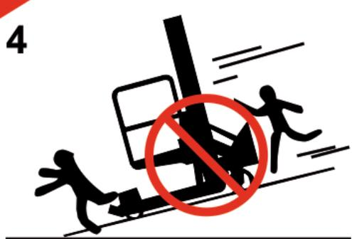
Не оставляйте подъемник на наклонной плоскости. При движении по склону следите за препятствиями
