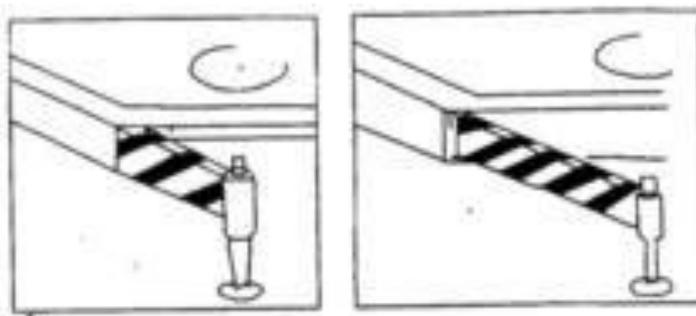
Подключите питание или выберите автономный режим, поверните ручку включения и загорится индикатор, нажмите кнопку подъема или опускания, подъемная платформа будет подниматься и опускаться.
